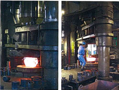
1200℃に熱した金属を、8000トンのプレス機にかけ、金属の中心を抜き、リング状になるよう広げていく
