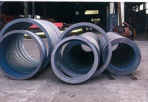
でき上がったリング鍛造品は、納品後用途に合わせて加工される
